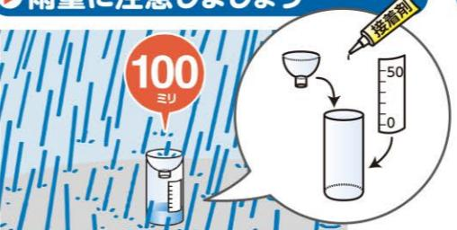
円筒型のペットボトルの上部を切断し、図のように口を逆さにして接着剤で固定します。目盛りを付ければ簡易雨量計の完成です。
